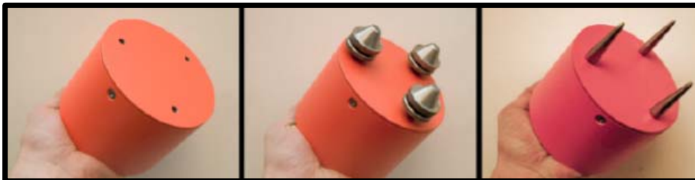
Figura A. 1 - Versione "GEMINI HVSr" basale impiegata per la prospezione sismica passiva: dettaglio dei supporti intercambiabili in dotazione, da sostituire a seconda che si acquisisca su superficie rigida o su terreno.
